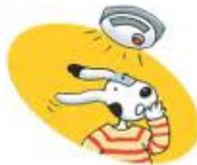
Installez un avertisseur de fumée par étage, y compris le sous-sol. Fixez-les au plafond ou sur les murs à une distance de 10 à 30 cm du mur ou du plafond.
